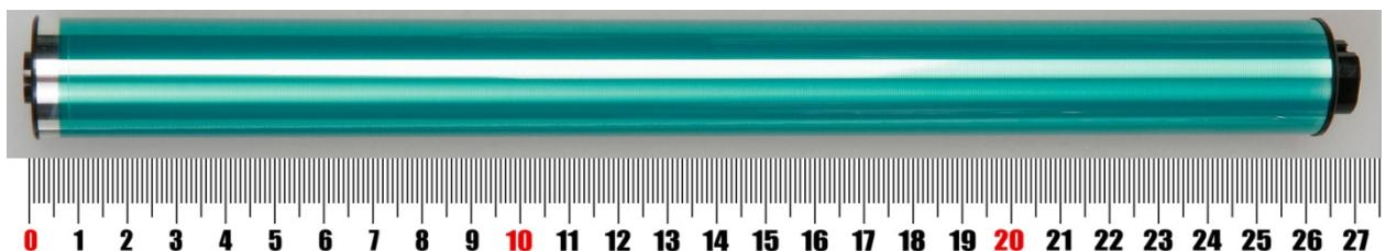
3. Покрытие на барабане прозрачное (свет отражается от алюминиевой поверхности барабана), это покрытие имеет при обычном освещении зеленые оттенки.
